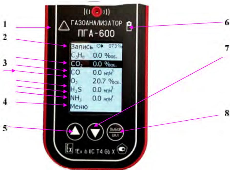
1 – красный светодиод индикации превышения порогов; 2 – строка ЗАПИСЬ; 3 – показания измерительных каналов; 4 - строка МЕНЮ (активное состояние: темный фон, белый шрифт); 5– кнопка « $\Delta$ »; 6 – зеленый светодиод индикатора заряда; 7 - кнопка « $\leftarrow$ »; 8 - кнопка ВЫБОР/ВКЛ
