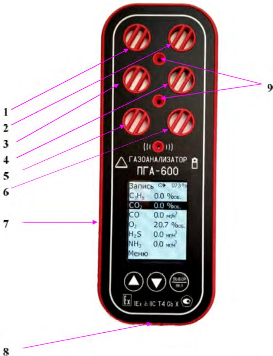
1 – датчик пропана  $C_3H_8$ ; 2 - датчик углекислого газа  $CO_2$ ; 3 - датчик оксида углерода  $CO$ ; 4 - датчик кислорода  $O_2$ ; 5 - датчик сероводорода  $H_2S$ ; 6 - датчик аммиака  $NH_3$ ; 7 – корпус газоанализатора; 8 – разъем microUSB для заряда и подключения газоанализатора к компьютеру (закрыт заглушкой); 9 - места для винтов крепления калибровочной камеры
